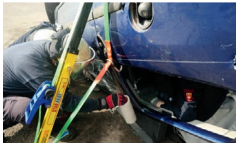
Bei dem gesicherten Fahrzeug werden die Scheiben entfernt.
