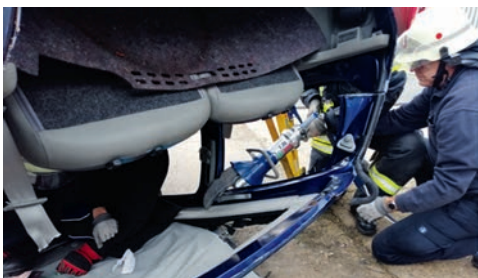
Die Rettungsschere durchtrennt das Dach.
