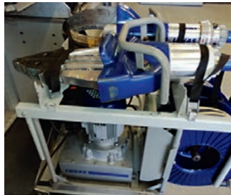
Hydraulische Rettungsschere und hydraulischer Spreizer; richtige Kraftprotze: Die Schere bringt es auf 105 Tonnen Schneidgewicht.
