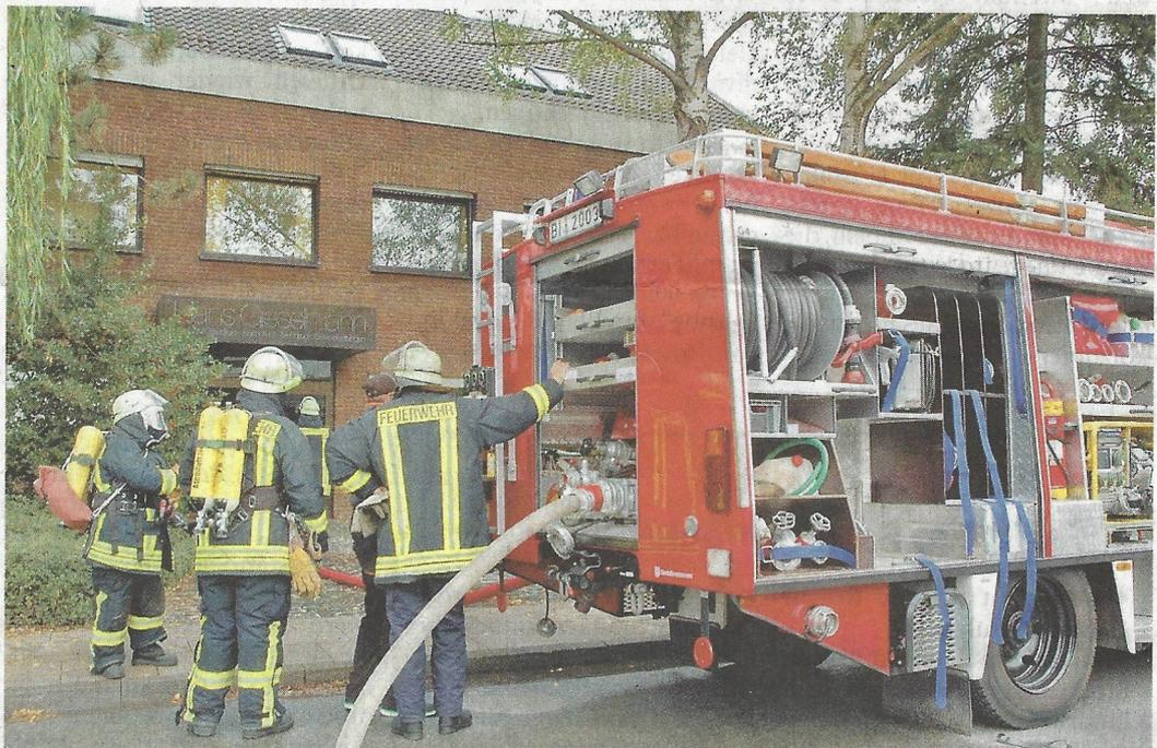
**Vor der Druckerei:** Beim Tanklöschfahrzeug der Queller Feuerwehr macht sich ein Trupp Atemschutzgeräteträger einsatzbereit, während der Pumpenmaschinist die Druckanzeige für die C-Rohre im Ausgabehäk
