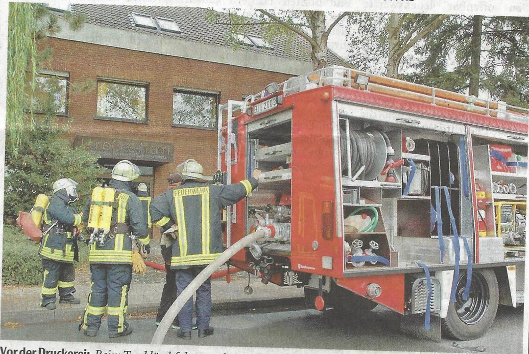
Vor der Druckerei: Beim Tanklöschfahrzeug der Queller Feuerwehr macht sich ein Trupp Atemschutzgeräteträger einsatzbereit, während der Pumpenmaschinist die Druckanzeige für die C-Rohre im Auge behält.
